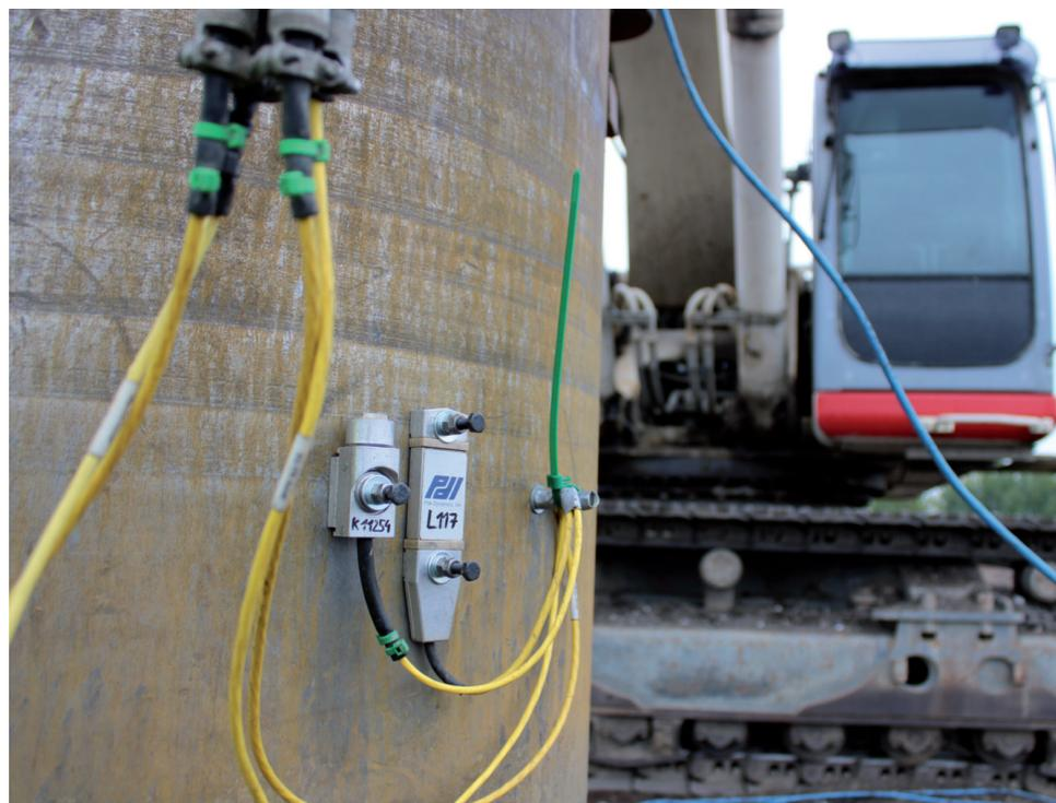
*Beschleunigungssensoren und Dehnungsmessstreifen am Verdichtungsfuß*
