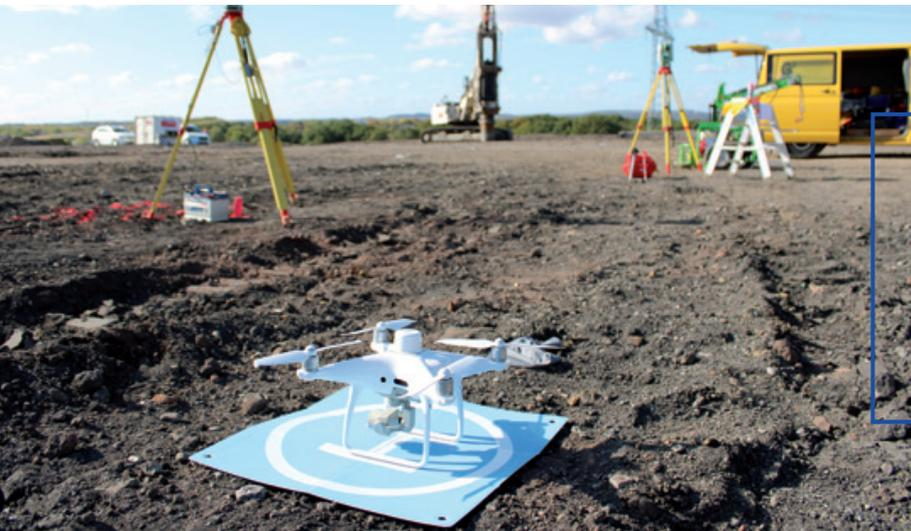
Einen neuen Blickwinkel auf die Geotechnik ermöglicht uns seit 2022 unsere Vermessungsdrohne DJI P4 RTK. Aus der 3D-Geländemodellierung von Baustellen können wir im Rahmen der Verdichtungsforschung zusätzliche Informationen generieren.
