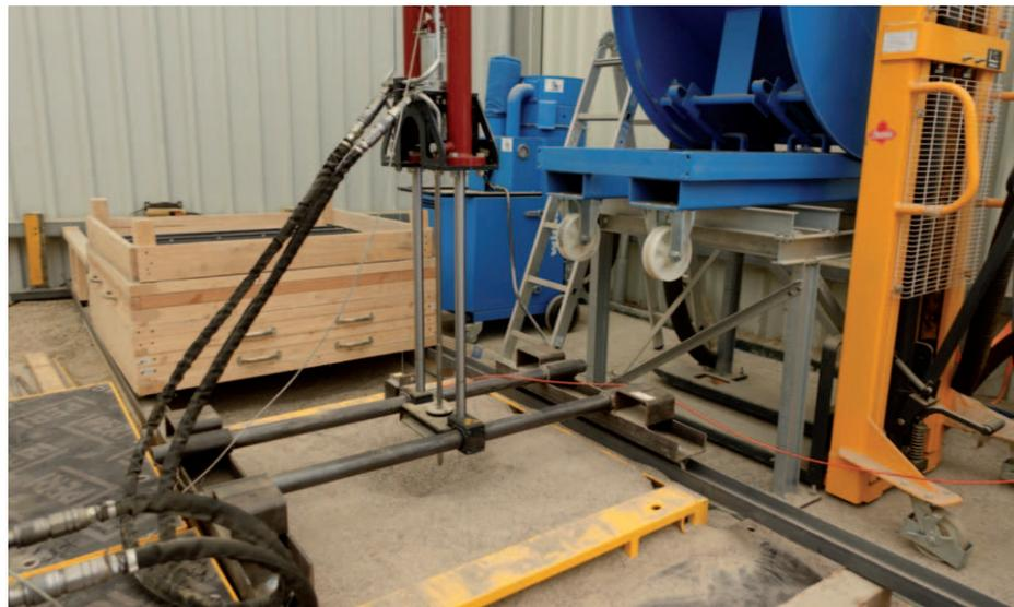
Links: Neu konstruierter Verdichtungsfuß mit installierter Sensormesstechnik
