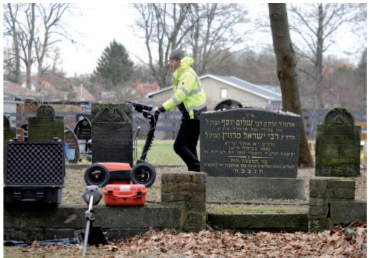
Felix Oertel bei Arbeiten mit dem Bodenradar zur Erfassung von Bodenstrukturänderungen
