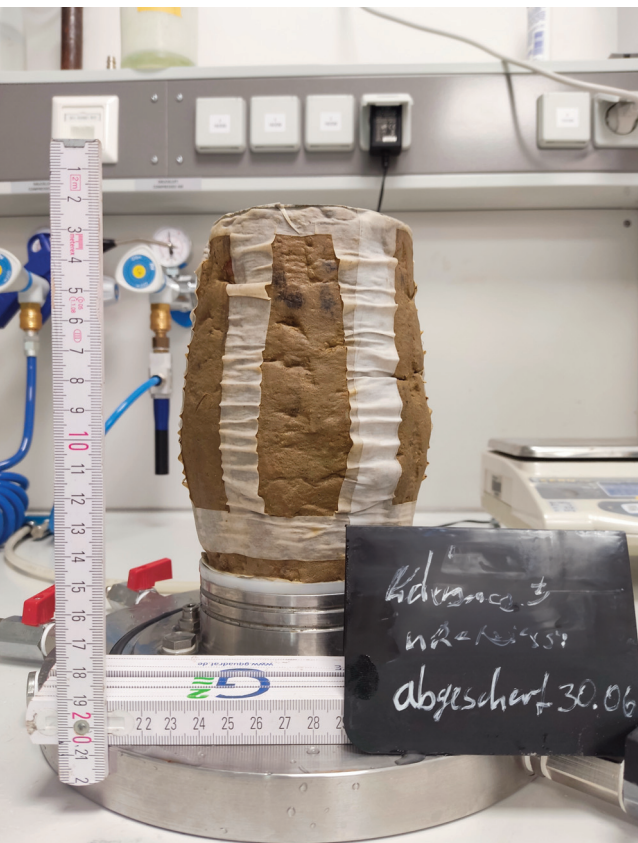
Bodenprobe im Triaxial- versuch mit innovativer Messtechnik bestückt
