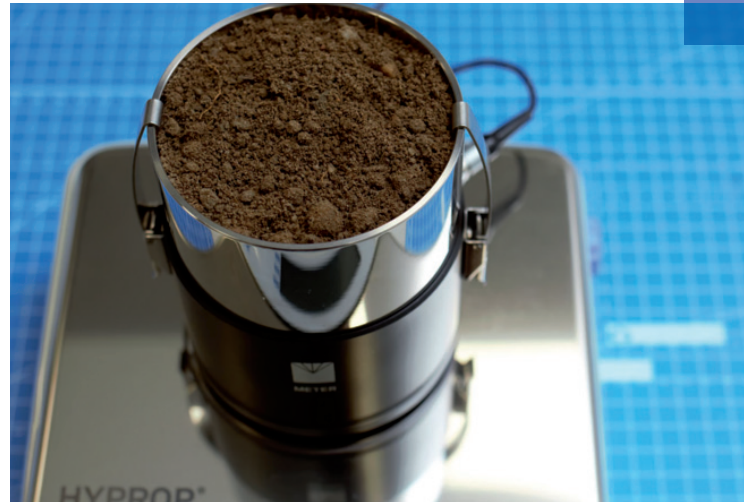
Bestimmung der nutzbaren Feldkapazität im Labor
