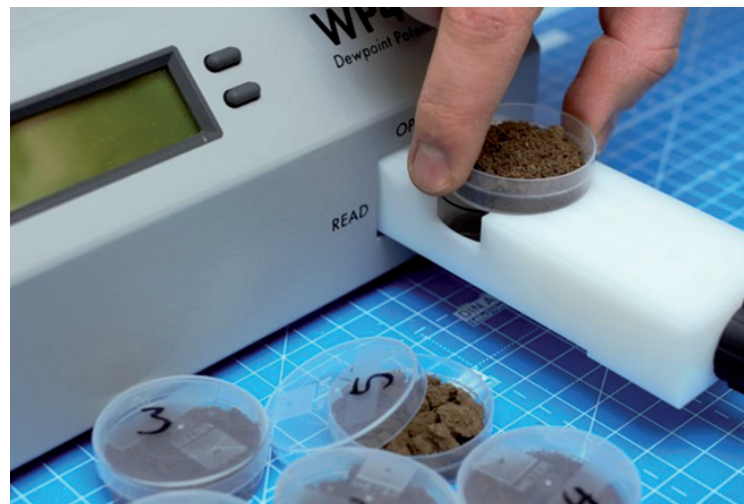
Ermittlung der Saugspannung für sehr trockene Böden durch Taupunkt-Messung
