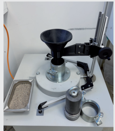
Versuchsvorbereitung für Rütteltischversuch
