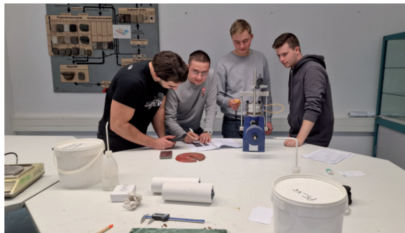
Laborpraktikum Bodenmechanik, hier: Ödometerversuch
