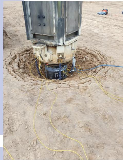
*Instrumentierter Messfuß bei der Impulsverdichtung bei einem Feldversuch*
