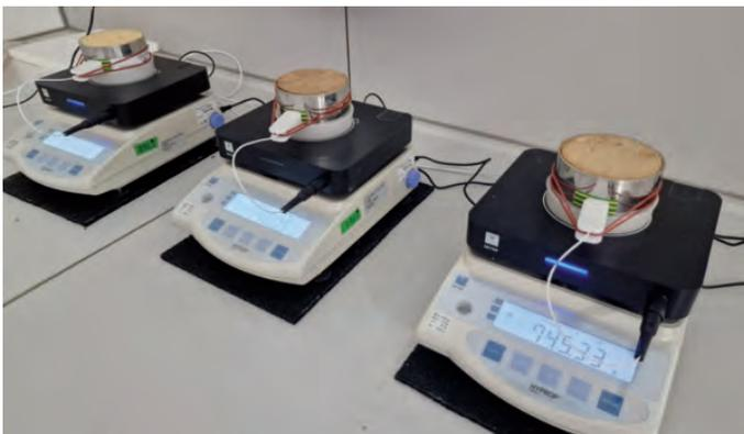
*Proben während der Messung der Wärmeleitfähigkeit*
