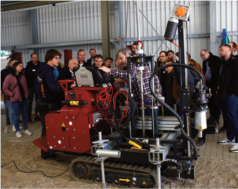
Drucksondier- vorführung mit Mini-CPT-Raupe im GeoTechnikum
